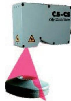
C5-CSセンサーでレーザーラインの形状を記録
